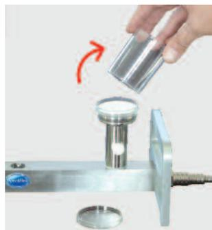
Rimozione del cilindro
